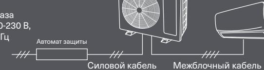
Примечание: Подключение электропитания осуществляется через клеммное соединение
