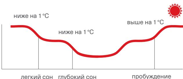
Кондиционер автоматически увеличит (в режиме охлаждения) или уменьшит (в режиме обогрева) температуру на 1 °C в час, в первые 2 часа, а через 5 часов выключится. Функция «Комфортный сон» помогает поддерживать наиболее комфортную температуру 25 °C и экономит электроэнергию.
